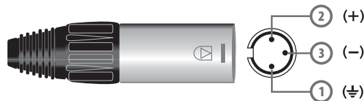
输入 INPUT 平衡连接 公座 XLR
