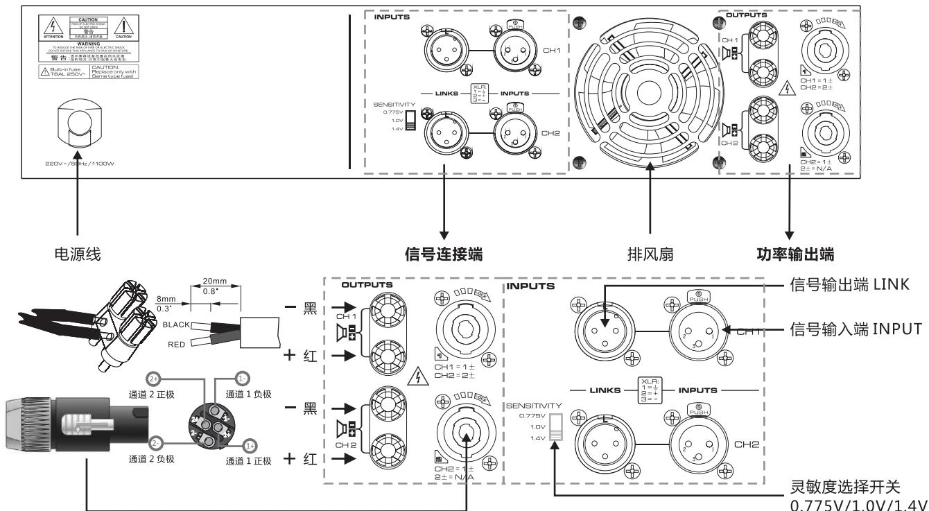
**⚠ 灵敏度选择应根据音频系统配置、使用场合、适用人群等要求，因选择不匹配可能导致产品损坏。**
