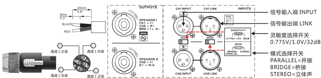
**!** 灵敏度选择应根据音频系统配置、使用场合、适用人群等要求，因选择不匹配可能导致产品损坏。
