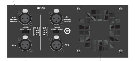
平衡XLR输入 CH1,CH2,CH3,CH4输入连接引脚2正极,引脚3负极,引脚1接屏蔽(接地). 建议用于放大器与信号源之间的长或短距离使用...... 风扇通风口 建议在使用过程中, 请不要堵塞出风口. 输入连接
