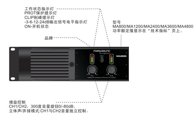
桥接模式:CH1同时控制两通道音量衰减,CH2音量控制失效。
